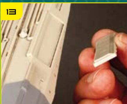
Деталь 6 имеет одно скошенное ребро в соответствии с рельефом ниши TP-11.
