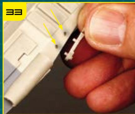
Деталь 17 крепится к двум указанным отверстиям на ребре TP-11.
