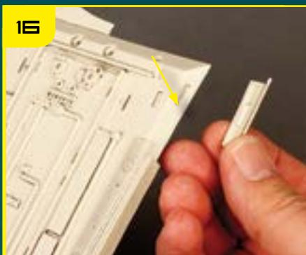
Вклейте деталь 8 в вытянутое углубление на ребре TP-11.
