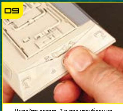
Вклейте деталь 3 в два углубления на переднем ребре TP-11.
