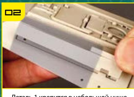
Деталь 1 крепится в небольшой нише на ребре TP-11, а ее цвета соответствуют покраске основной обшивки.
