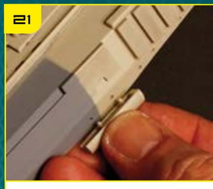
Вклейте штифты детали 11 в два отверстия на ребре TP-11.
